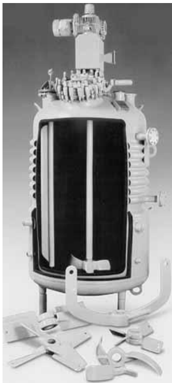
Σχήμα 2.1. Τομή βιομηχανικού Ομοιογενούς Αντιδραστήρα συνεχούς λειτουργίας (CFSTR) μέσης κλίμακας, όπου φαίνεται ο μηχανικός αναδευτήρας με διάφορα είδη
