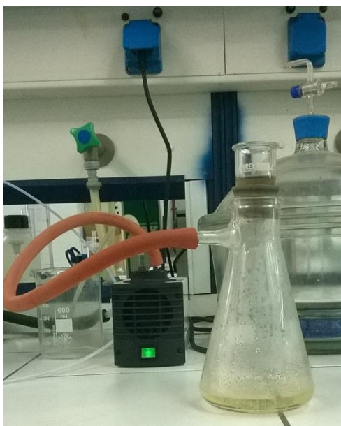
Διήθηση με ηθμό Gooch και μηχανική αντλία κενού.
