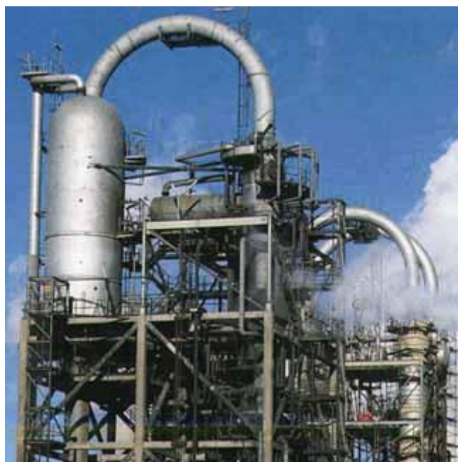
Σχημα 4.2. Αντιδραστήρας καταλυτικής σύνθεσης υδρογονανθράκων του γενικού τύπου (\text{CH}_2)_x , με τη μέθοδο Fisher-Tropsch: x\text{CO}_2 + 2x\text{H}_2 \xrightarrow{230^\circ\text{C}, 20-30\text{atm}} (\text{CH}_2)_x + x\text{H}_2\text{O}
