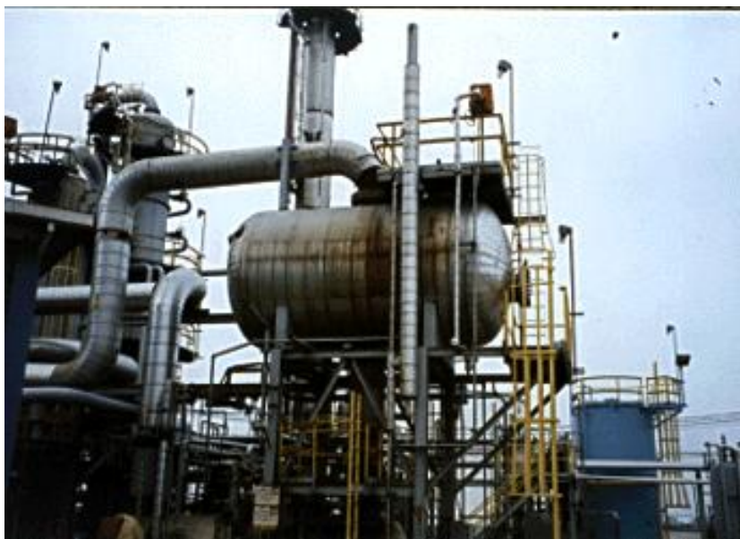
Σχήμα 4.1. Αντιδραστήρας με πληρωτικά υλικά (σταθερής κλίνης) που χρησιμοποιεί καταλύτη κοβαλτίου / μολυβδαινίου για τη μετατροπή του αερίου ρυπαντή διοξειδίου του θείου ( \text{SO}_2 ) προς υδρόθειο ( \text{H}_2\text{S} ), που μπορεί να μεταφερθεί / μετατραπεί περαιτέρω σε θείο ( \text{S} ) και να χρησιμοποιηθεί για την παραγωγή θειικού οξέος ( \text{H}_2\text{SO}_4 ), το οποίο είναι με τη σειρά του πρώτη ύλη για πολλά προϊόντα (π.χ. φωσφορικά και αζωτούχα λιπάσματα, κατεργασία σιδήρου / χάλυβα, εξευγενισμό πετρελαιοειδών, παραγωγή απορρυπαντικών, χρωμάτων, υφανσίμων ινών και χαρτιού).
