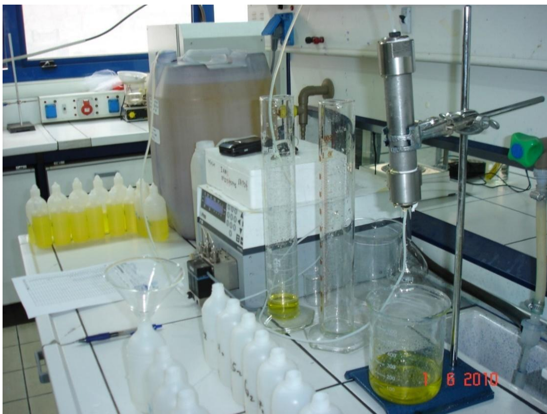
Στήλη προσρόφησης ύψους 15 cm. Από ανοξείδωτο χάλυβα με αντλία HPLC.
