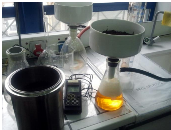
Ηθμός Buchner όπου γίνεται η διήθηση υπό κενό, αριστερά το δοχείο του αντιδραστήρα και στη μέση το pH-μετρο.
