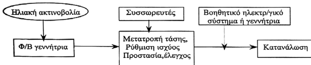
Σχήμα 2.89: Τυπική διάταξη μιας φωτοβολταϊκής εγκατάστασης.
