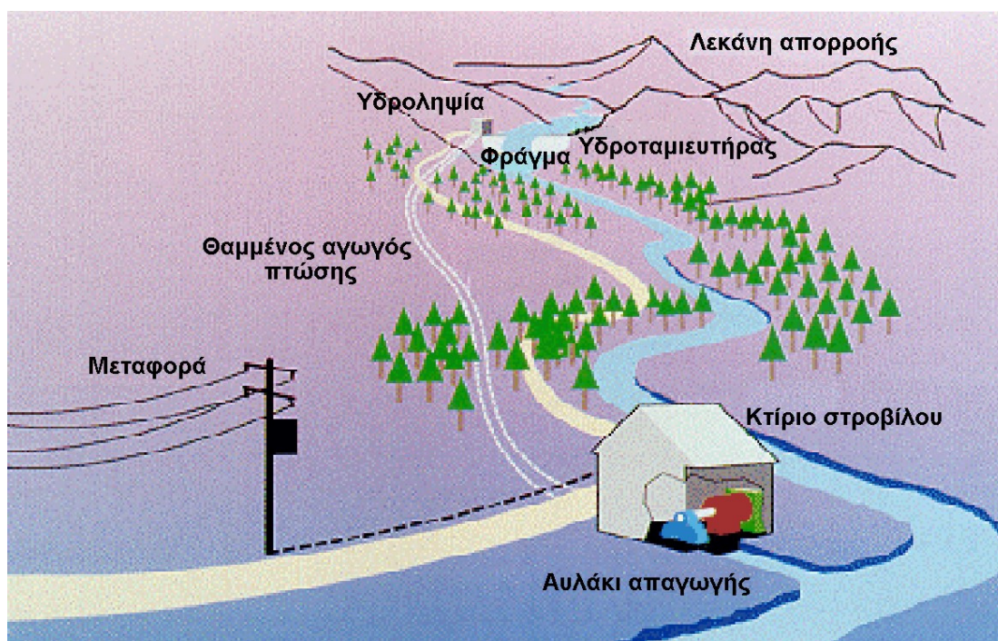
Σχήμα 2: Τα μέρη ενός υδροηλεκτρικού σχήματος
